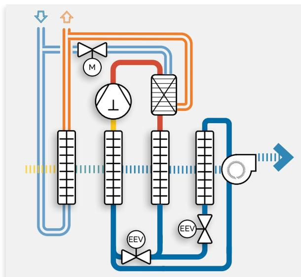
Unità di **deumidifica e integrazione** per sistemi integrati ai pannelli radianti, per il controllo e il mantenimento del valore di umidità, sui limiti impostabili. L'unità è composta da:
